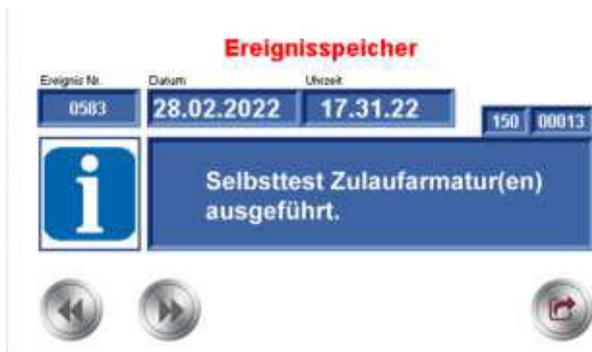
Die Steuerung erfüllt nicht nur die Anforderungen nach DIN 14462, sondern überwacht auch alle wichtigen Funktionen mittels Selbsttests. So wird der Betreiber entlastet, indem Funktionstests, die ansonsten manuell durchzuführen wären, durch die Anlagensteuerung selbsttätig ausgeführt werden.
