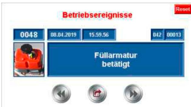
Alle wichtigen Komponenten der Anlage werden über die Steuerung überwacht und durch automatische Selbsttests fortlaufend auf einwandfreie Funktion geprüft. Störungen werden somit nicht erst beim Einsatz im Brandfall erkannt, sondern können in der Regel schon früher identifiziert werden.
