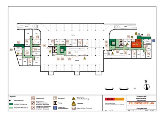
Feuerwehrpläne dienen Einsatzkräften als Lagebeurteilung und liefern wichtige Informationen, die eine rasche Orientierung innerhalb und außerhalb eines Gebäudes ermöglichen. Sie geben Aufschluss über Zugangswege, Brandschutz- und Löscheinrichtungen sowie Gefahrenschwerpunkte. Feuerwehrpläne tragen damit dazu bei, Menschenleben zu retten wie auch Sach- und Umweltschäden zu begrenzen.
